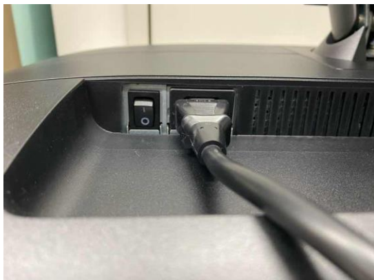
電源ケーブルの接続
